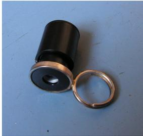
Nahfokus-Monokulare mit Standardwerten: 4x12, 6x18, 8x30, 8x20; ein Galileisches Monokular mit Fingerring.
